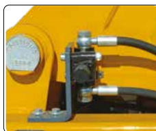
Doppio effetto. Single acting - double acting automatic switch.
